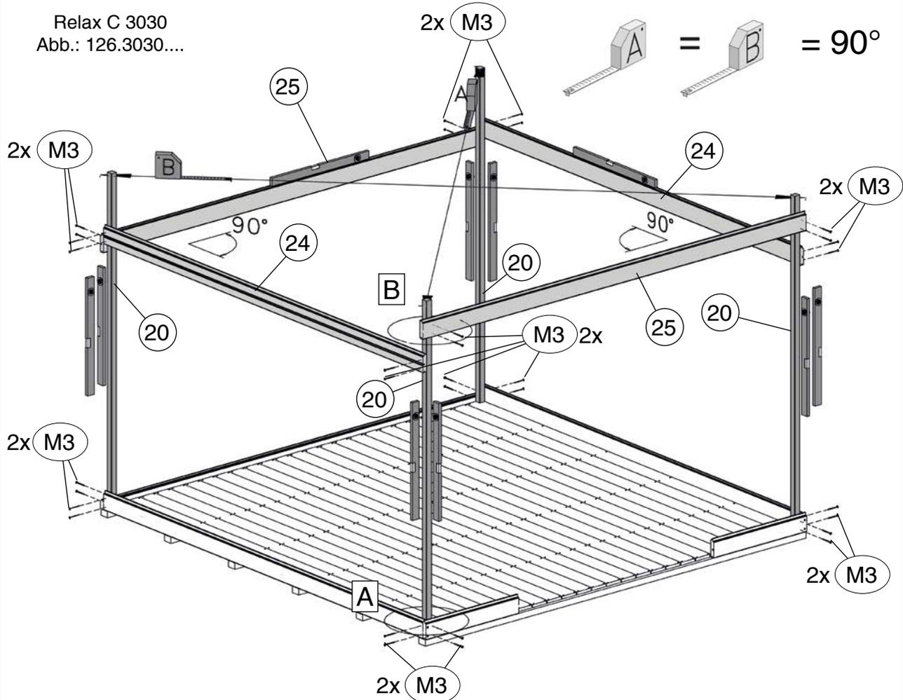
Die oberen Wandbohlen werden nur vorübergehend als Montagehilfe befestigt ( Abb.5), später wieder abgenommen und an anderer Stelle montiert. (Abb.9)
